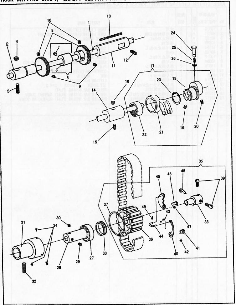
下軸、下ベルトプーリー、送りカム HOOK DRIVING SHAFT, SAFETY CLUTCH PULLEY
