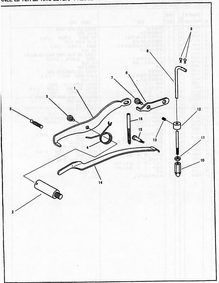
大弓、押え棒大板ばね KNEE LIFTER LIFTING LEVER PRESSER BAR SPRING
