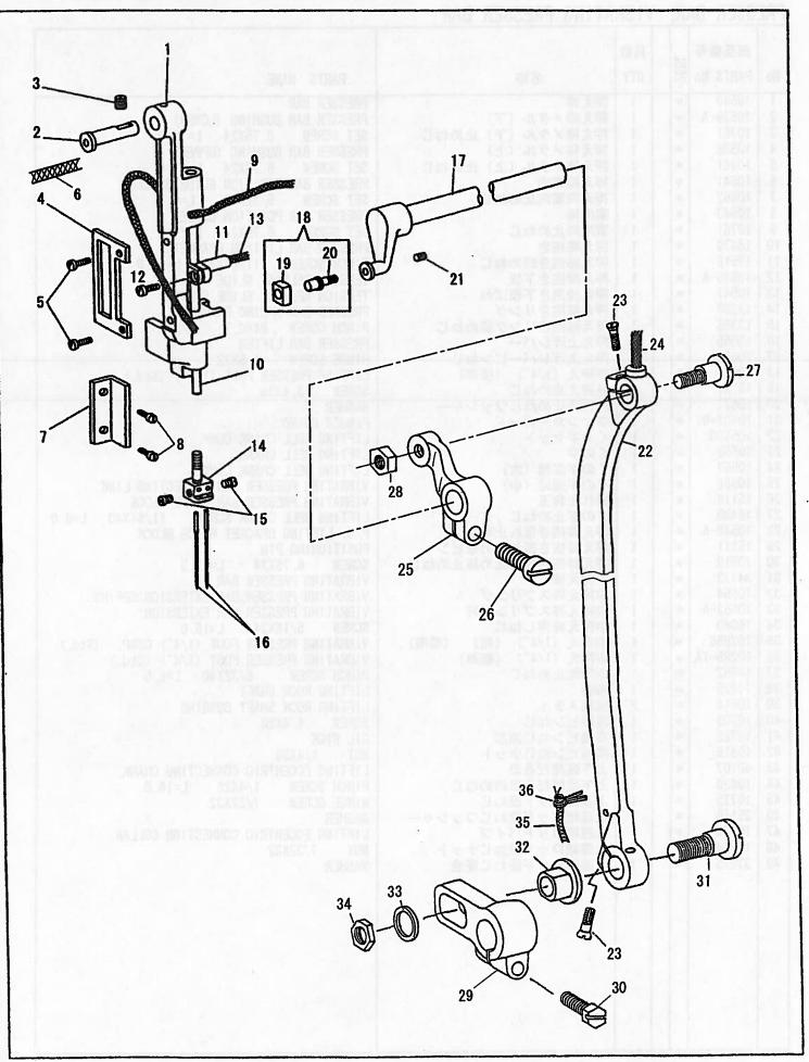
針棒土台、連結ロッド NEEDLE BAR ROCK FRAME, ROCK SHAFT CRANK CONNECTION
